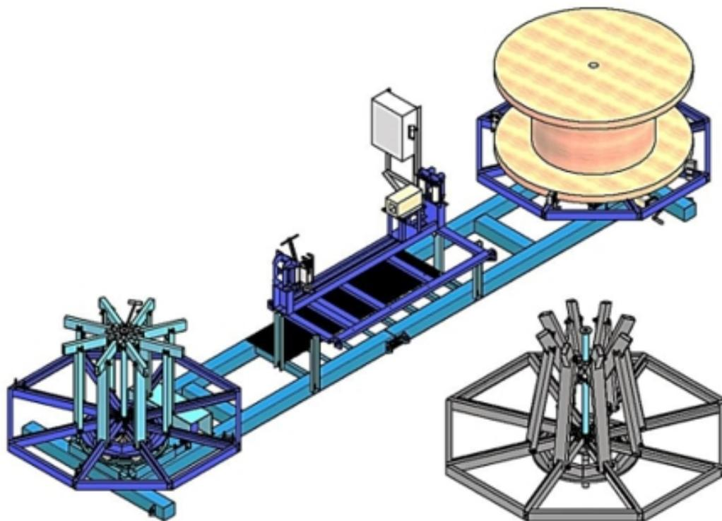
Комплекс ВПК-64 предназначен для мерной перемотки стального каната с отдающего модуля на принимающий модуль, с возможностью резки.
