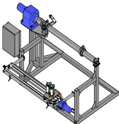
Модуль предназначен для намотки стального каната на деревянный барабан, оснащен механическим или автоматическим каната укладчиком, с помощью которого происходит рядная укладка каната на барабан. Имеется возможность установки устройства измерения длины наматываемого каната.
