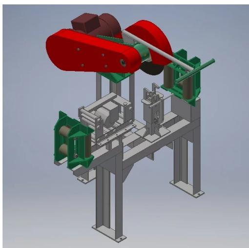
Модуль предназначен для резки стального каната на мерные отрезки.
