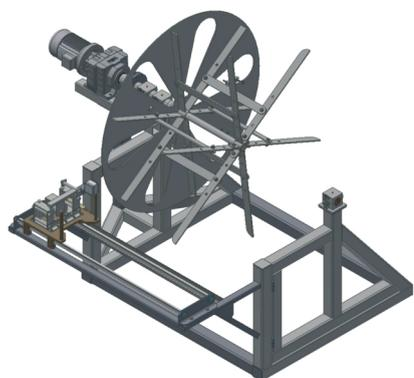
Модуль предназначен для перемотки стального каната, с возможностью формирования бухт на технологический складной барабан.
