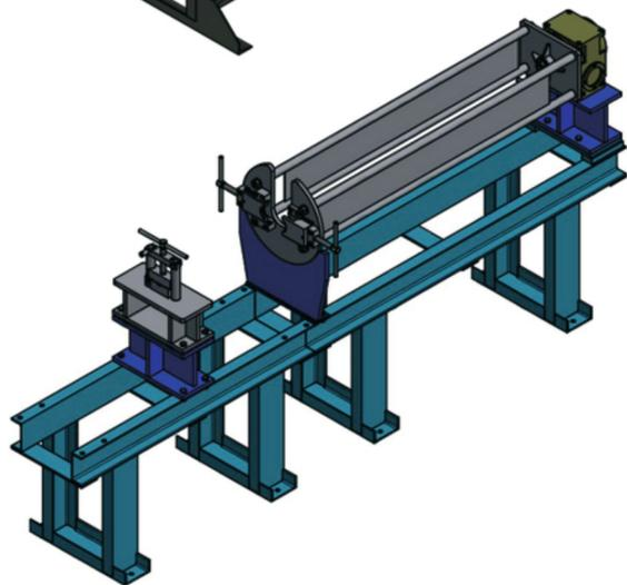
**Оборудование для ручной заплетки:** механизированные вертикальные и горизонтальные установки ИРМАШ, стали незаменимым инструментом для ручной заплетки, которые значительно облегчили процесс изготовления строп из стального каната.
