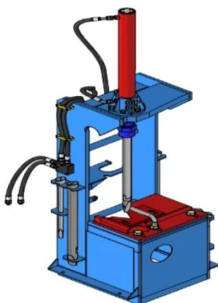
Преимущества способа заделки концов стальных канатных стропов машинной заплеткой с проколом каната иглой с гидравлическим приводом:
