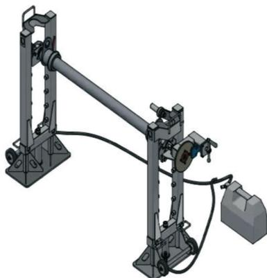
Устройство состоит из двух одинаковых мобильных грузоподъемных стоек, на опорные траверсы которых устанавливаются транспортный барабан с канатом с предварительно установленной в его отверстие опорной осью.
