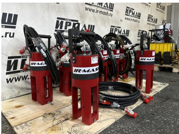
**Гидравлические прессы для опрессовки, стыковки стержневой арматуры (ПП-А)** - предназначены для механического соединения стержневой арматуры муфтами. Идеально подходит для использования как на стройплощадке при монтаже армокаркасов, так и в заводских условиях.
