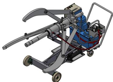
Съемник предназначен для демонтажа крупногабаритных подшипников и различных деталей и узлов (шкивов, шестерён, втулок и т.п.), имеющих посадку с натягом, и является средством механизации при проведении различных ремонтных работ.
