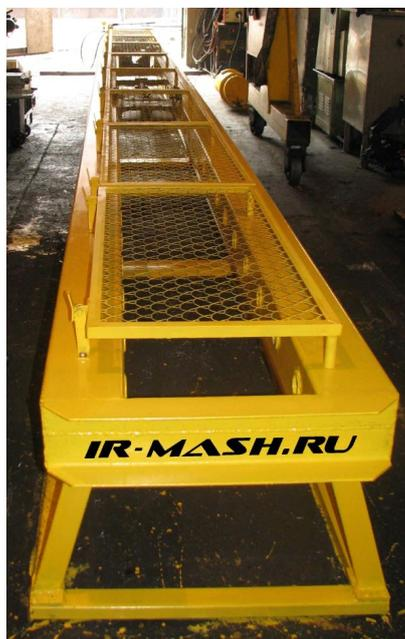
Стенд предназначен для испытания растяжением канатных, цепных и текстильных стропов.
