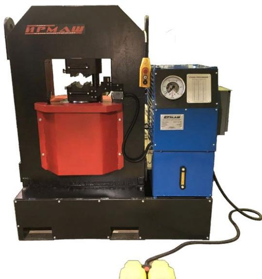
Пресс представляет из себя раму с насосной станцией расположенными на одном основании, что обеспечивает компактность оборудования.
