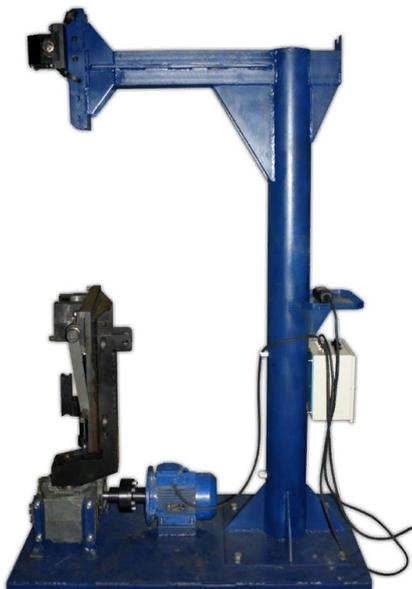
Приспособление предназначено для механизации раскручивания заплетаемой части каната при заделке концов стальных канатных стропов ручной заплёткой.
