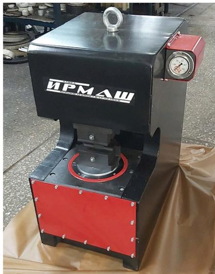
Пресс предназначен для изготовления стропов путем опрессовки давлением стальных канатов втулкой из металлических сплавов.
