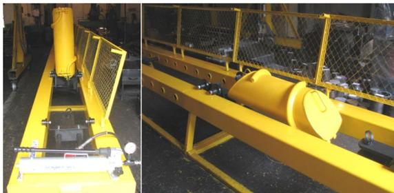
Позволяет испытывать стропы длиной до 40м путем их навивки на специальный блок.
